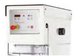
VL-1S Commande automatique de la vitesse et abaissement automatique de la cuve.
